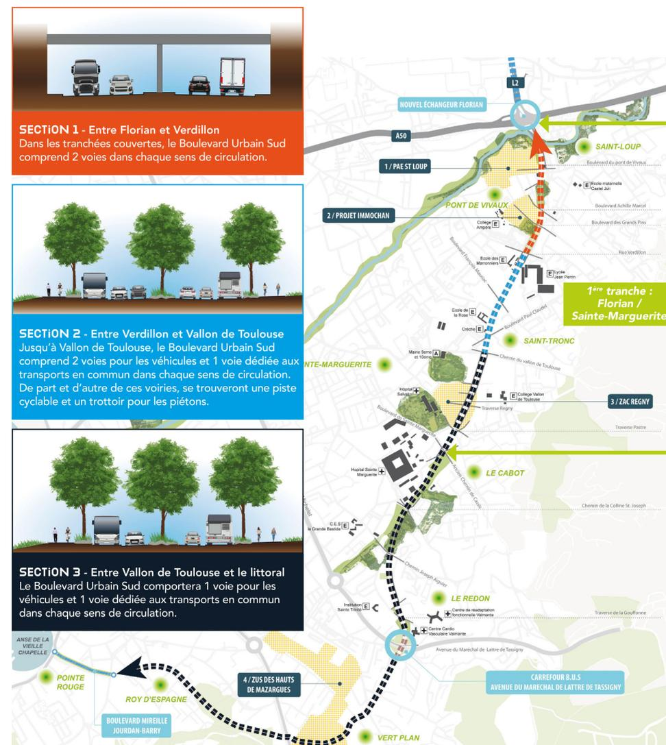
FIG. 16. Schéma des travaux du B.U.S. Source : Plaquette du Boulevard Urbain Sud disponible sur le site internet de la Métropole Aix-Marseille-Provence.
