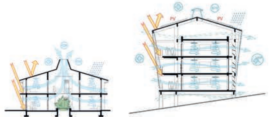
PRINCIPE CLIMATIQUE : COUPE AÉRAULIQUE À L'ÉCHELLE DES BÂTIMENTS
