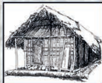
KUPAMBÁ : structure en châssis de bois (coco ou bambou) sur laquelle est assemblé un lattis de raphia (ou bambou) à
