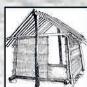
KETI KETI : modèle assez proche du buru. Les panneaux sont constitués de nervures de feuilles de cocotiers
