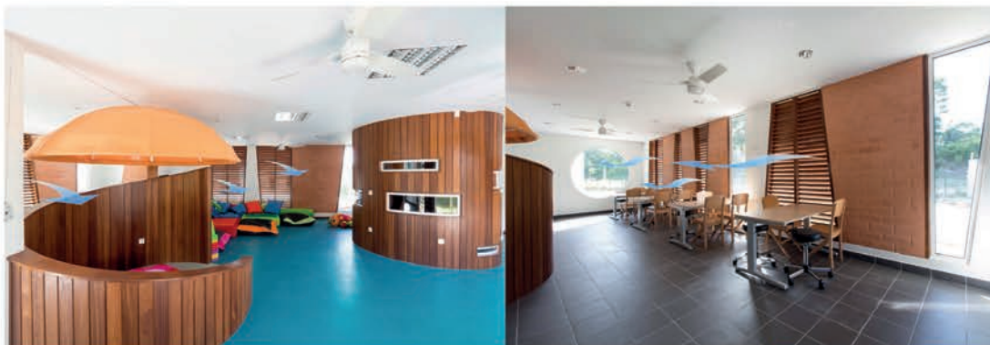
LA FAIBLE ÉPAISSEUR DU BÂTIMENT PRINCIPAL PERMET LA VENTILATION NATURELLE DES LOCAUX D'ACTIVITÉS GRÂCE À UNE CIRCULATION INTÉRIEURE RENDUE POREUSE PAR DES JALOUSIES MOBILES. CETTE DISPOSITION PARTICULIÈRE QUI A FAIT L'OBJET DE DISCUSSIONS APPROFONDIES AVEC LES SERVICES D'INCENDIE ET DE SECOURS A NÉCESSITÉ UN TEMPS D'ADAPTATION DE LA PART DES UTILISATEURS. UNE INTERVENTION DE LEUR PART EST EN EFFET NÉCESSAIRE POUR GARANTIR LA VENTILATION TRAVERSANTE OPTIMALE DES LOCAUX.
