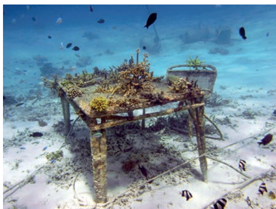
Premier prototype de mobilier en accrétion minéral - M.A.F. - 1 an après sa mise à l'eau au large de l'île de Gili trawangan en Indonésie. Photo : Foued Kaddachi / 2013
