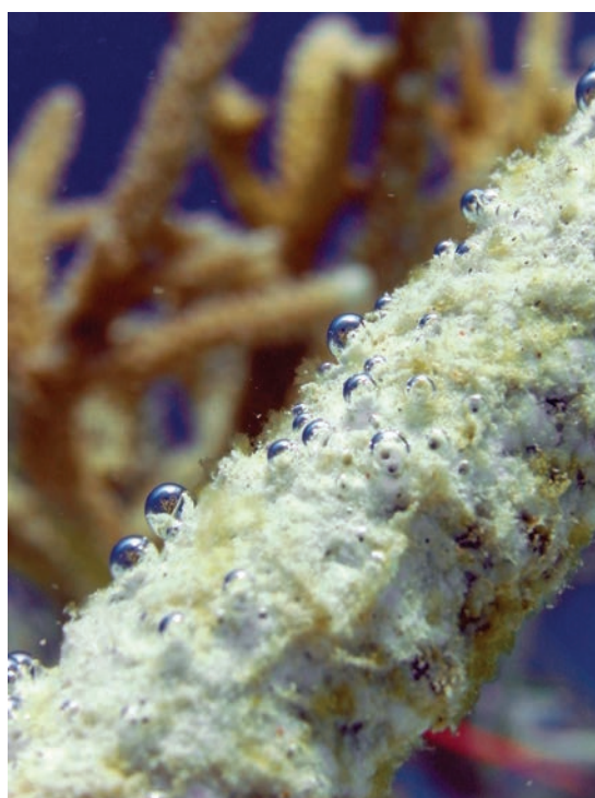
De petites bulles d'Hydrogène se forment autour de la structure. Elles témoignent du bon fonctionnement du dispositif d'accrétion minérale. Photo : Foued Kaddachi / 2013
