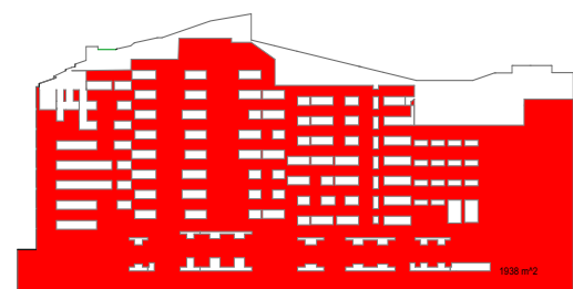
123/ Façade nord schématique : en rouge l'enduit
