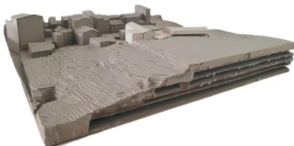
La **maquette creuse** est la technique la plus efficace et simple pour réaliser une topographie tout en économisant du carton. Le principe étant de ne pas couper systématiquement les couches de carton en prenant l'intégralité du cadrage. On positionne en bas des cales pour soutenir les couches de cartons.
