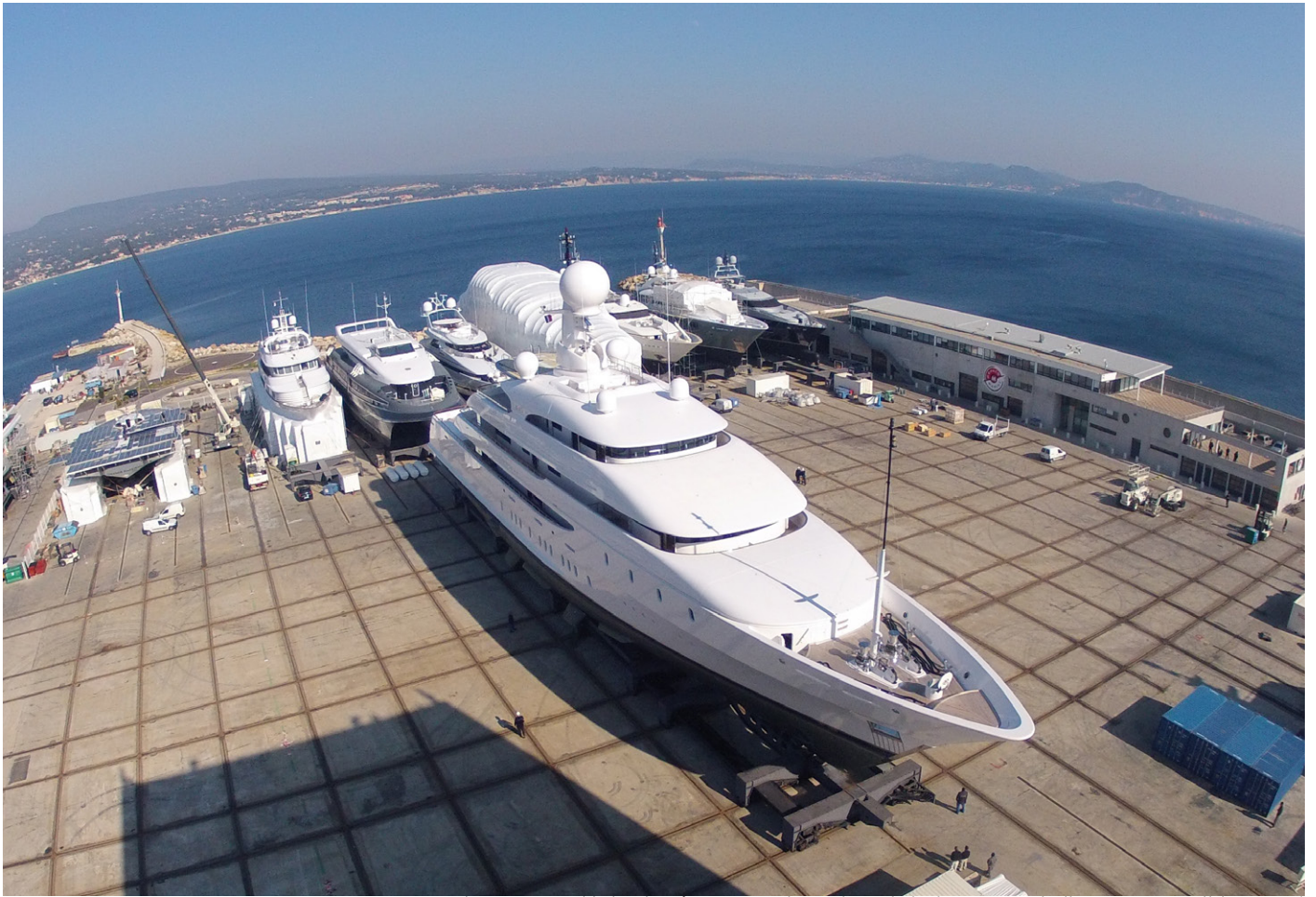
Une bateau est déplacé grâce au système de rails bidirectionnels (lesactus.canalblog.com)
